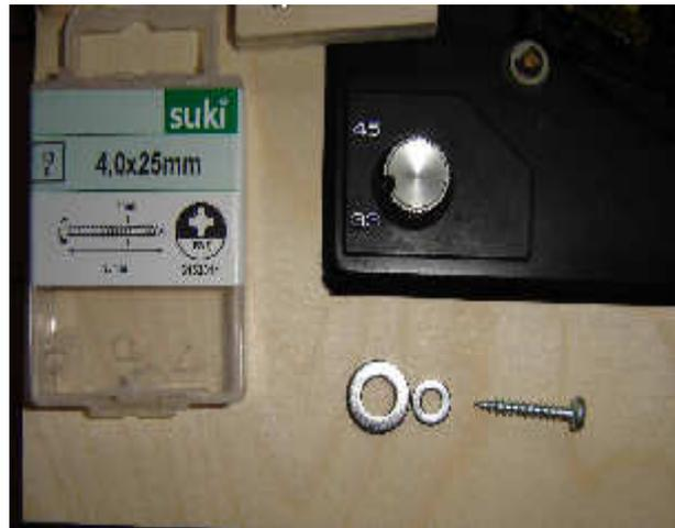
Hier die Montage der Knebel für das 2017er Chassis. Bei dem rechten Bild kommt die große U-Scheibe unter den Knebel.
